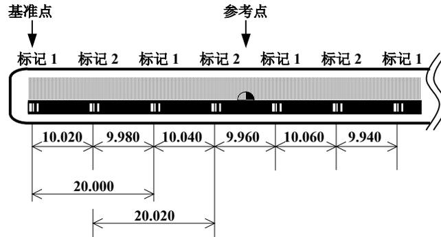
从基准点看在十方向有参考点时设定一正值，在一方向有参考点时设定一负值。设定步骤如下所示。
