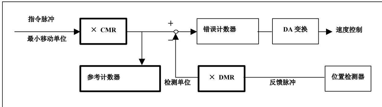
设定 CMR 和 DMR 的倍率，以使至错误计数器的正输入（来自 CNC 的指令）和负输入（来自检测器的反馈）的脉冲权重相同。
