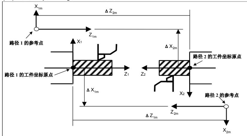
路径1在工件坐标系上的路径2的参考点位置为(ΔX<sub>1m</sub>, ΔZ<sub>1m</sub>)，路径2在工件坐标系上的路径1的参考点位置为(ΔX<sub>2m</sub>, ΔZ<sub>2m</sub>)。在路径1的参数(No.8184x)中设定ΔX<sub>1m</sub>，在路径2的参数(No.8184x)中设定ΔX<sub>2m</sub>。
